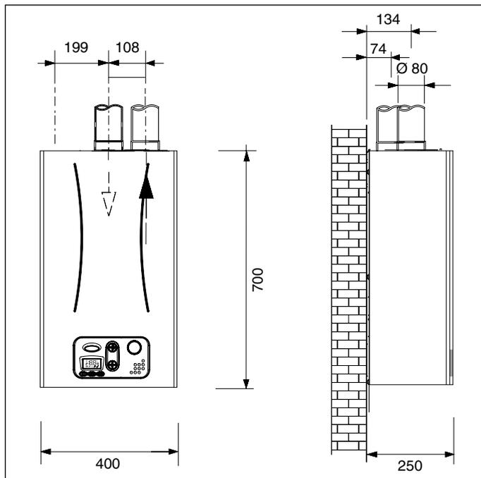
Рис. 17 Размеры для подсоединения отдельных труб воздухоподачи/дымоотвода
